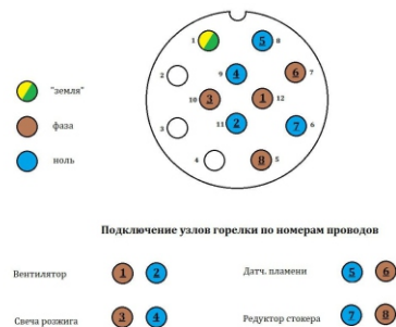
Разъем кабеля подключения горелки и контролера
